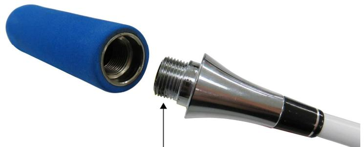
ネジ部に接着剤を塗布し、締め付けて固定する設計になっておりますが、接着剤の塗布量が少なく、接着不足になり回転してしまう製品が発生しております。
